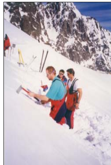
Obrázok 2 Vykonanie Nórskej sondy v teréne
