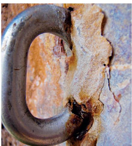
Obr. 4: Príklad korózneho napadnutia borháku.
