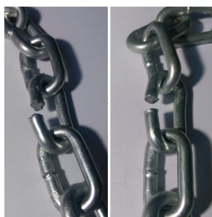
Obr. 6 Necertifikovaná reťaz 8 mm, vľavo po skúške tahom, vpravo iné miesto po skúške tahom.
