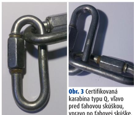
Obr. 3 Certifikovaná karabína typu Q, vľavo pred táhovou skúškou, vpravo po táhovej skúške.
