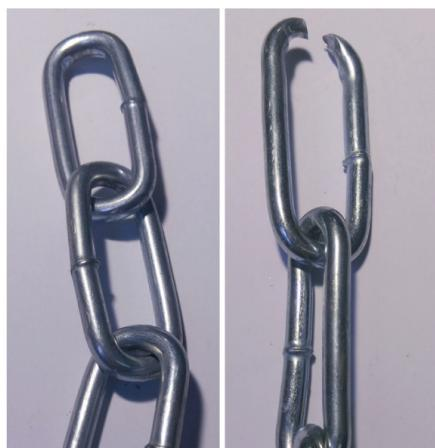
Obr. 5 Necertifikovaná reťaz priemeru 6 mm, vľavo pred skúškou, vpravo po skúške.
