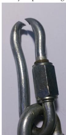
Obr. 4 Necertifikovaná karabína typu Q po pevnostnej skúške tahom.
