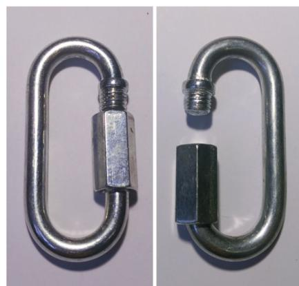
Obr. 2 Necertifikovaná karabína typu Q, vľavo pred tahovou skúškou, vpravo po tahovej skúške.
